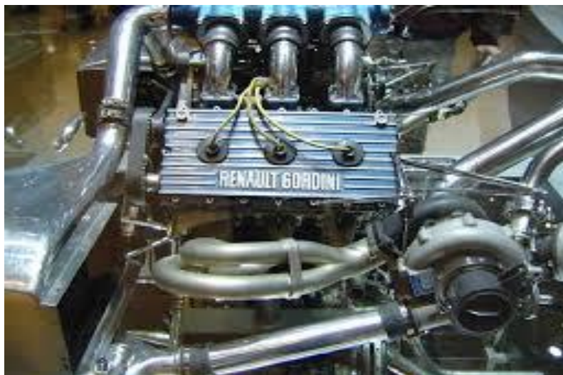
Motor Renault turbo com cerca de 500 HP
